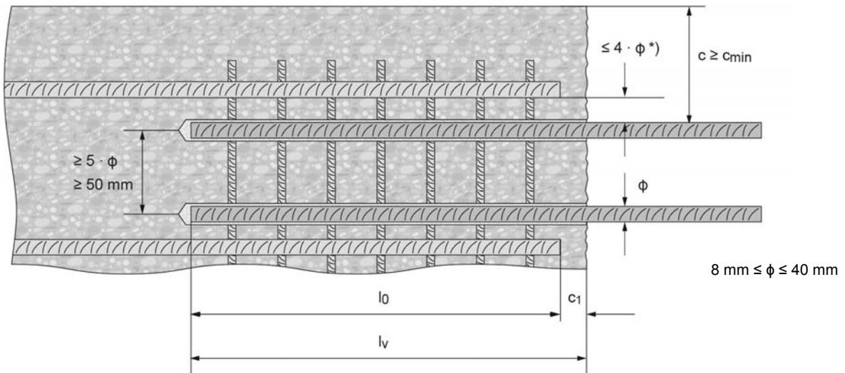
\*) Ist der lichte Abstand der gestoßenen Stäbe größer als  $4 \cdot \phi$ , so muss die Übergreifungslänge um die Differenz zwischen dem vorhandenen lichten Stababstand und  $4 \cdot \phi$  vergrößert werden.
