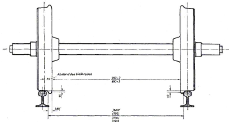
Der Durchmesser des Maßkreises ist der Raddurchmesser im Abstand von 55 mm von der inneren Stirnfläche des Rades
